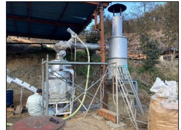
【伊那東部山村再生支援研究会】 設置された移動式汎用型炭化器
