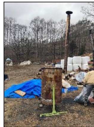
②ドラム缶を改造した炭化器
